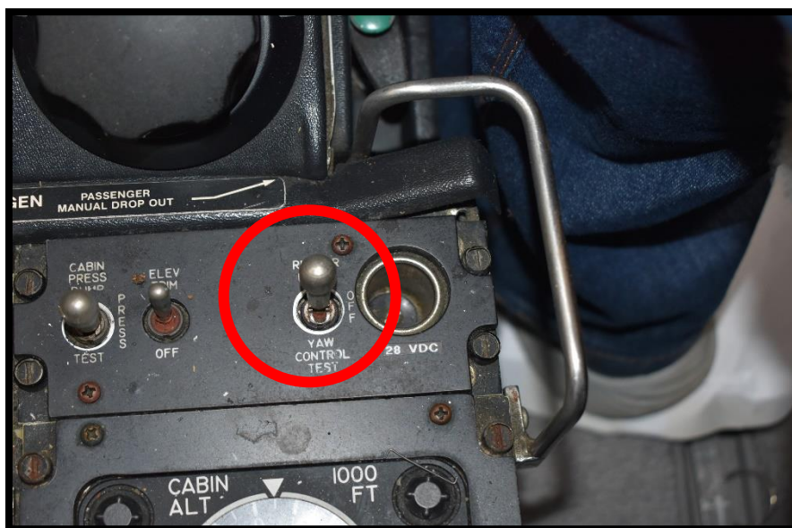
Fotografía No. 21 Nótese el switch de Yaw Damp en posición ON.
